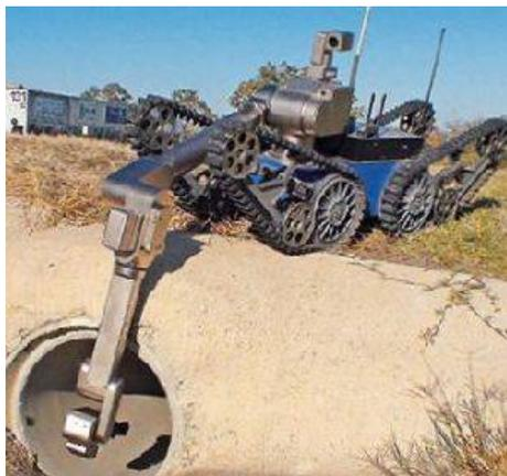
Робот для обезвреживания бомб Telemax был специально адаптирован для операций, которые должны выполняться в узких пространствах, таких как самолеты, подземные поезда или автобусы. Везде, где более крупная модель не может работать, Telemax обеспечивает сохранение жизненно важного расстояния между сапером и бомбой. Сервоприводы Elmo Whistle и Tweeter - это очень практичный выбор, они могут быть установлены в соединениях манипулятора.
