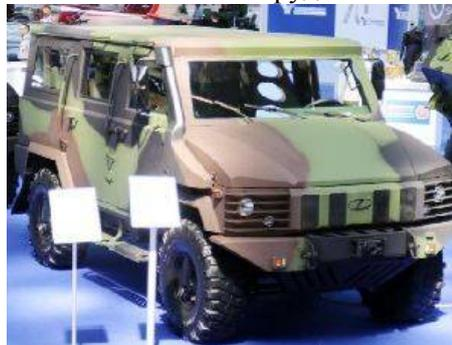
Zastava 1 NTV (New Terrain Vehicle - Новый вездеход) - внедорожная тактическая машина 4x4, предназначенная для перевозки личного состава и оборудования весом до 1400 кг или буксировки прицепа с максимальной грузоподъемностью 1700 кг.
