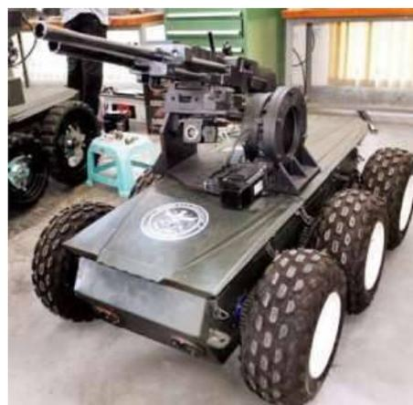
Разработанный для обращения с взрывчатыми веществами и взрывными устройствами, дистанционно управляемый робот Daksh скоро получит вооружение, большую мощность и приборы ночного видения.
