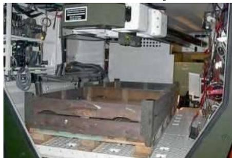
Адекватное и своевременное пополнение запасов имеет важное значение для успешного выполнения боевой задачи. Грузовой вариант *Boxer* Cargo/C способен подвезти бод защитой брони более двух тонн предметов снабжения до подразделения на поле
