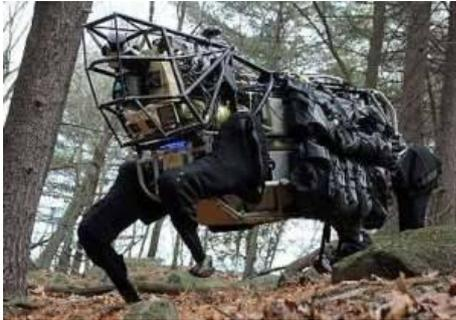
Агентство перспективных исследовательских проектов Министерства обороны США (DARPA) провело первое полевое испытание опытного образца своей новой разработки - полуавтономного четвероногого робота, Ходячей системы поддержки отделения - Legged Squad Support System (LS3), предназначенной для переноски тяжелых грузов для спешенного подразделения в сложных условиях местности.
