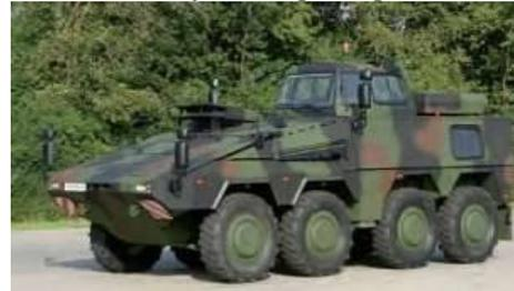
В машине может находиться до 5 человек экипажа, с водителем в отделении управления. Преподаватель и один член экипажа (возможно, экзаменатор по вождению) сидят на возвышении в отделении подготовки водителей. Два других члена экипажа размещаются в задней части модуля подготовки водителей.
