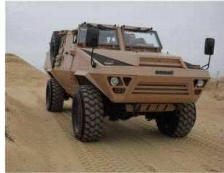
Машина имеет открытый верх, что позволяет размещать на ней тяжелое оружие и ракетные пусковые установки, системы разведки, наблюдения и целеуказания, а также выполнять роль контрольно-пропускного пункта и проводить специальные операции. Особенностью Bastion PATSAS является применение хорошо отработанного, известного своей надежностью колесного шасси 4x4.
