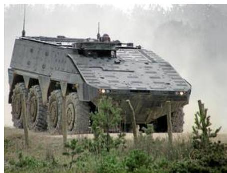
Boxer — германо-голландская многоцелевая колёсная бронированная машина, предназначенная для использования в мотострелковых подразделениях сухопутных войск.
