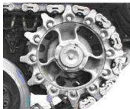
Ведущее колесо танка - составная часть гусеничного движителя, предназначенная для перематывания гусеничной ленты (гусеницы) и преобразования собственного вращательного движения в поступательное движение танка.
