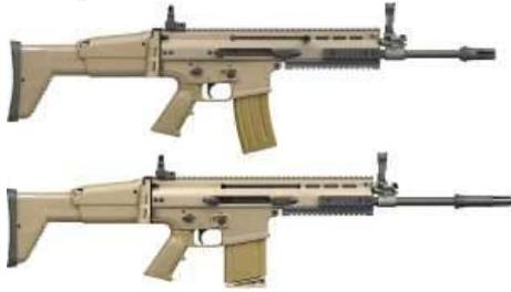
Штурмовая винтовка SCAR-L STD имеет камору под патрон калибра 5,56 x 45 мм НАТО и оснащена стандартным стволом 14,5 дюймов. Для ближнего боя стрелок может заменить стандартный ствол коротким 10-дюймовым стволом менее чем за пять минут, превратив оружие в вариант SCAR-L CQC. Для повышения огневой мощи на винтовку может крепиться подствольный гранатомет FN40GL-L.
