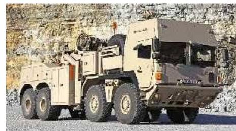
Тяжелая тактическая ремонтно-эвакуационная машина (HTRV - Heavy Tactical Recovery Vehicle) весом около 36 тонн базируется на испытанных и проверенных колесных шасси SX45 с колесной формулой 8x8 немецкого совместного предприятия Rheinmetall MAN Military Vehicles GmbH (RMMV). Оно сочетает высокие безопасность и комфорт экипажа с выдающейся маневренностью, будь то на дороге или на сложной пересеченной местности.
