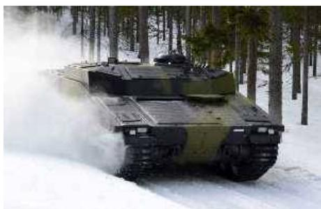
Armadillo (Броненосец) - это безбашенная версия боевой машины CV90 с баллистической и противоминной защитой, которая превышает требования Stanag 4a/b. Удаление башни дает дополнительных шесть тонн запаса по полезной нагрузке для размещения дополнительной защиты или для других целей, а современная электронная архитектура дает возможность применять новые системы plug-and-play.
