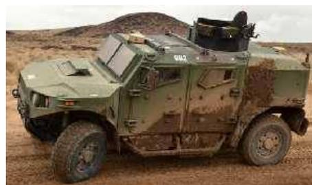
Армия США начала проведение испытаний живучести первых двух из трех сверхлегких машин (ultra light vehicle - ULV) в штатах Невада и Мэриленд, чтобы подтвердить их возможности противоминной и баллистической защиты.
