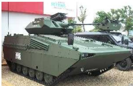
На прошедшей недавно выставке Eurosatory-2014 чешская компания EXCALIBUR ARMY spol. s r.o. представила боевую машину пехоты, на которой была установлена башня Samson Mk II израильской компании Rafael, вооруженная пушкой калибра 30 мм и противотанковыми ракетами Spike.
