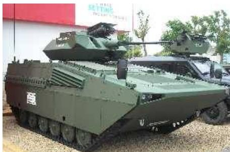
На прошедшей недавно выставке Eurosatory-2014 чешская компания EXCALIBUR ARMY spol. s r.o. представила боевую машину пехоты, на которой была установлена башня Samson Mk II израильской компании Rafael, вооруженная пушкой калибра 30 мм и противотанковыми ракетами Spike.
