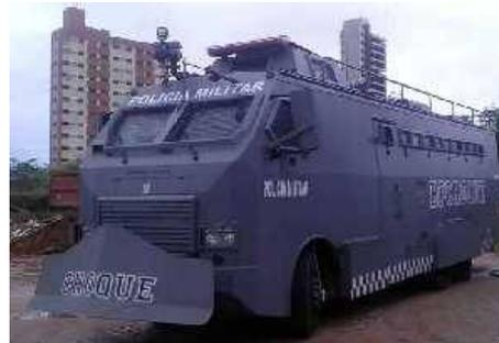
Конструкция бронетранспортера отражает подход Plasan, предполагающий самостоятельное общее проектирование, производство и установку систем. В качестве базы использована коммерческая машина с колесной формулой 4x4, которая была переоборудована в машину 6x6, чтобы обеспечить соответствие требованиям по защищенности и размещению всех необходимых систем в границах заявленной стоимости.
