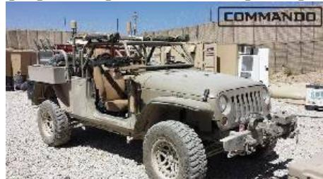
Еще одна машина на базе Jeep, которая уже используется в армии и была предложена для участия в программе ULCV — это Commando Jeep, разработанная Hendrick Dynamics. Hendrick Dynamics отличается низким силуэтом, специальными креплениями и доработками для транспортировки по воздуху и может быть быстро переоборудована для выполнения различных задач.
