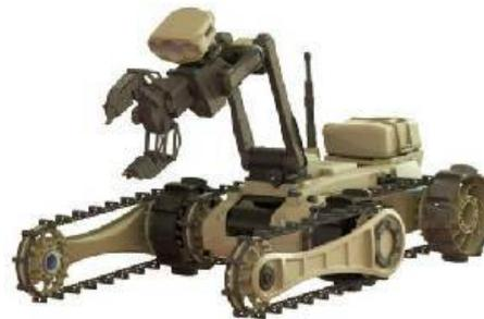
В снаряженная масса MTGR 7,3 - 8,6 кг, он может нести полезную нагрузку в 10 кг, и работать в течение 2-4 часов, преодолевая расстояние до 500 метров, двигаясь в помещении или на открытом воздухе, по дороге или через плотную растительность, по улицам и подземным ходам.
