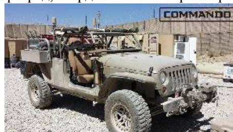
Еще одна машина на базе Jeep, которая уже используется в армии и была предложена для участия в программе ULCV – это Commando Jeep, разработанная Hendrick Dynamics. Hendrick Dynamics отличается низким силуэтом, специальными креплениями и доработками для транспортировки по воздуху и может быть быстро переоборудована для выполнения различных задач.
