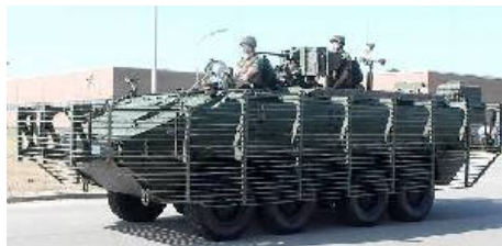
Во время первой репетиции военного парада к Национальному Дню 21 июля 2015 года бельгийская армия представила новую усовершенствованную версию бронетранспортера Piranha 3C 8x8 путем установки на него навесной решетчатой брони.
