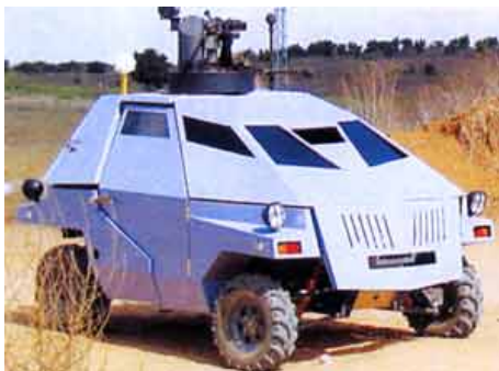
Созданная на базе вездехода Tomcar TM27GL, Avantguard оснащена двигателем Daihatsu мощностью 900 лс, а также патентованной современной роботехникой и датчиками.
