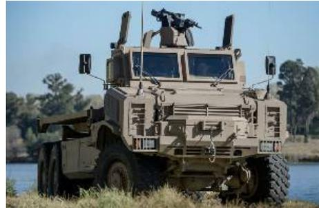
Прочные мосты имеют блокируемые дифференциалы, параболические рессоры с гидравлическими амортизаторами двойного действия, а также шины 16.00 R20 на отдельных дисках 10.0x20. Рулевое управление с гидравлическим усилителем.
