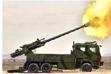
Гаубица калибра 155 мм с длиной ствола 52 калибра имеет электрические привода наведения и электронное управление, а также полуавтоматическую систему подачи снаряда. Орудие может вести огонь стандартными артиллерийскими снарядами НАТО калибра 155 мм.
