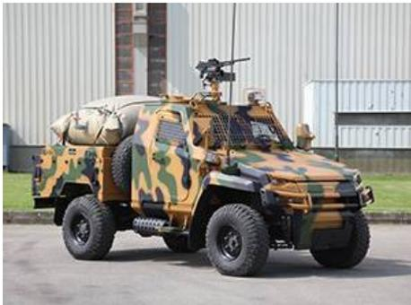
Машина оснащена бронированной кабиной, моторным отсеком и возможностью посадки 1+1. Сверху на кабине установлен пулемет с возможностью вращения на 360 градусов. Кормовое отделение спроектировано таким образом, что оно может быть легко и быстро трансформировано персоналом с помощью специального фиксирующего механизма, обеспечивающего быстрое переконфигурирование для решения конкретных задач.
