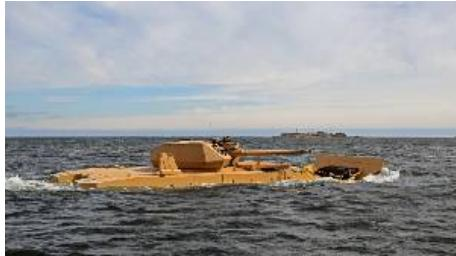
Бронетранспортер AMV28A от финской компании Patria успешно прошел испытания плавом, которое было организовано в конце мая в Финляндии. Как и ожидалось, машина общим весом 28 тонн, плавала без проблем. Patria AMV28A (где 28A - означает 28-тонная машина-амфибия, испытывалась при трехбалльном волнении), последний представитель семейства Patria AMV, впервые представленный на мероприятии IDEX 2017 в начале этого года.
