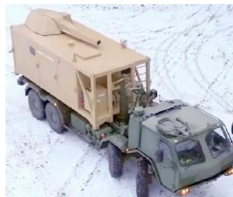
Финский производитель грузовых автомобилей, компания Sisu Auto, недавно приняла участие в живых огневых испытаниях, на которых прошел проверку грузовик 8x8 компании с системой автопогрузки вместе с Nemo Container от Patria.
