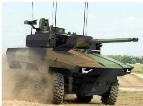
По бокам башни устанавливается по одной пусковой установке ракеты MMP (Missile Moyenne Portée - Ракета среднего радиуса действия), разработанной французской компанией MBDA. Ракета MMP — это ракета типа «выстрелил и забыл», с автоматическим самонаведением и максимальной дальностью стрельбы 4000 м.
