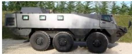
Демонстратор параллельного гибридного привода Elekter на базе колесного бронетранспортера VAB от Renault Trucks Defense (RTD), являющийся предметом «Программы изучения тенденций» (РЕА), которую французский Директорат по закупке вооружений (DGA) начал в 2012 году, прошел испытания в течение последних трех лет, проехав в общей сложности более 5000 км, половина из которых пришлась на бездорожье.
