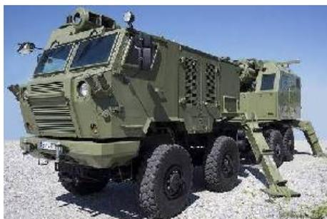
Сербская организация Yugoimport SDPR, занимающаяся импортом и экспортом военной продукции, провела испытания и продемонстрировала 21 ноября 2017 года в Объединенных Арабских Эмиратах (ОАЭ) колесную самоходную гаубицу Nora-B52 M15 калибром 155 мм с длиной ствола 52 калибра, сообщает министерство обороны Сербии.
