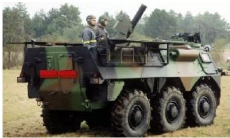
Французская армия в рамках программы модернизации SCORPION проведет испытания варианта бронетранспортера Griffon 6x6, оснащенного безотказным нарезным минометом калибра 120 мм 2R2M производства TDA Armements SAS.
