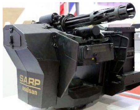
Стабилизированная система называется SARP-M134, где «SARP» обозначает Stabilised Advanced Remote weapon Platform (Стабилизированная современная дистанционная оружейная платформа). 6-ствольный пулемет M134 может выпускать до 3000 выстрелов в минуту, при этом машина может находиться в движении.
