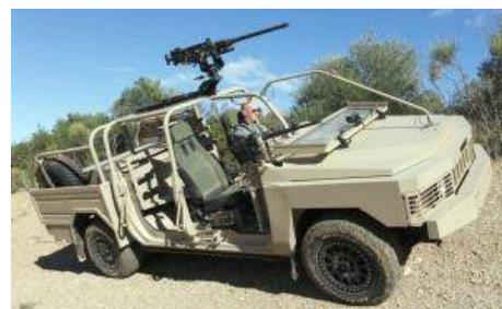
Линейка ALTV - это семейство, предназначенное для решения нескольких типов задач в области обороны. Например, машина может выступать в роли машины связи, а также как дозорная машина, или для борьбы с терроризмом. В версии Station Wagon, выбранной французской армией для замены P4, это просторный и надежный вездеход. Модульность конструкции позволяет устанавливать на нем несколько типов оборудования, такого как боевые модули и системы радиоподдержки.
