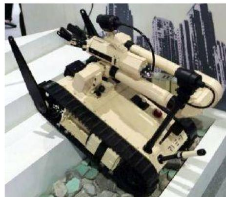
Тайская компания RV Connex представила робота RVE-1 с дистанционным управлением для обезвреживания самодельных взрывных устройств на выставке Defense & Security 2017 в Бангкоке, Таиланд.
