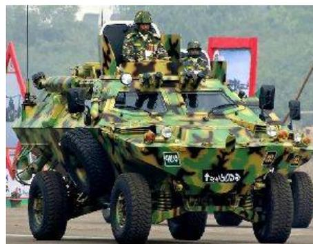
Согласно официальному RFP, среди технических требований армии Бангладеш на новую машину 4Ч4 содержатся такие, что машина должна работать в температурных условиях, превышающих 50°C, она должна будет иметь запас хода свыше 500 км, скорость движения 80 км/ч и более 25 км/ч в условиях бездорожья. Она также должна иметь удельную мощность более 20 л.с./т.
