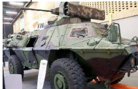
Myolnir T30 - беспилотная башня, которая будет устанавливаться на крыше бронированной машины Pegaso. Основное вооружение будет включать в себя одну 30-мм пушку и спаренный пулемет калибра 7,62 мм. Левая сторона башни также будет оснащена двумя пусковыми установками для противотанковой управляемой ракеты Spike, выпускаемой израильской компанией Rafael.
