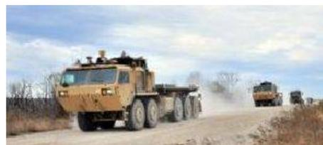
Навесная система обеспечения автономной мобильности AMAS (Autonomous Mobility Applique System) от Lockheed Martin выдержала более 100 000 км пробега во время расширенных испытаний армией США на полигонах в Форт Леонард Вуд, штат Миссури и Форт-Блисс, штат Техас (США).
