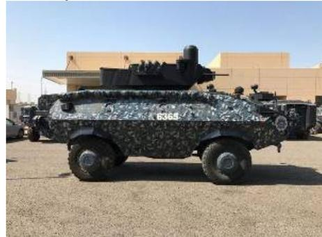
Устанавливаемые башни имеют большое количество сложного оборудования и оптики, в том числе тепловизионный прицел командира с высокой разрешающей способностью для дневного и ночного наблюдения, основной тепловизионный прицел наводчика, приборы наблюдения за окружающей обстановкой и акустическую систему обнаружения выстрелов. Вся эта система спроектирована и изготовлена в Великобритании.
