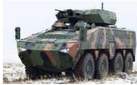
Varus - это вариант бронетранспортера Mbombe 8 от Paramount, который оснащен передовыми сухопутными системами. Машина была разработана для удовлетворения растущего спроса на многоцелевые высококомобильные и платформы с противоминной защитой.
