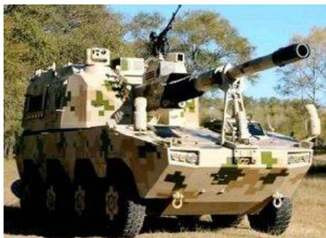
Китайская оборонная компания NORINCO разработала новую 155-мм 8-колесную самоходную гаубицу типа SH-11. Новая артиллерийская система будет представлена во время AirShow China 2018, которая пройдет в Чжухае (Китай) с 6 по 11 ноября 2018 года.
