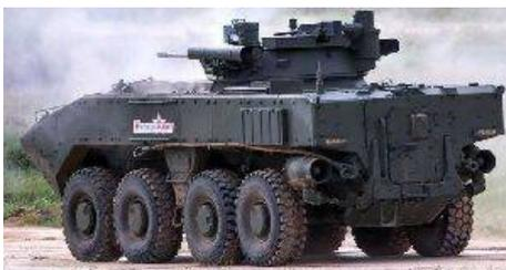
Российская боевая машина Бумеранг 8x8 ВПК 7829 была разработана компанией ВПК в двух конфигурациях: 25-тонная бронированная боевая машина К17 (БТР) и 22-тонный плавающий бронетранспортер (БТР) К16. Предназначенный для замены колесных бронетранспортеров, таких как БТР-80, на вооружении российской армии и пограничников, Бумеранг представляет собой новый подход во
