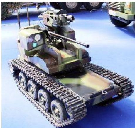
Гусеничный вооруженный робот Milosh теперь находится на вооружении сербских вооруженных сил. На выставке-ярмарке вооружения и военной техники Partner 2019 беспилотная машина Milosh демонстрировалась вооруженной одним 7,62-мм пулеметом и 40-мм гранатометом.
