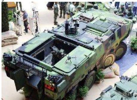
Броня СМ-32 обеспечивает защиту от огня стрелкового оружия калибром 7,62 мм с любого направления и 12,7 мм в лобовой проекции. Машина СМ-32 имеет V-образный цельносварной бронированный корпус.
