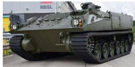
На выставке DSEI 2019 Soucy Defense демонстрирует БМП Warrior 510 с установленными на ней композитными резиновыми гусеницами (CRT), которые прошли 5 000 км испытаний в рамках Программы усовершенствования боевых возможностей Warrior (WAIP).
