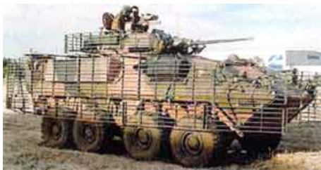
ASLAVы, австралийские легкие бронетранспортеры, которые находятся в Ираке, вскорости будут оснащены новой системой защиты, призванной обеспечить безопасность экипажа от гранатометных атак.
