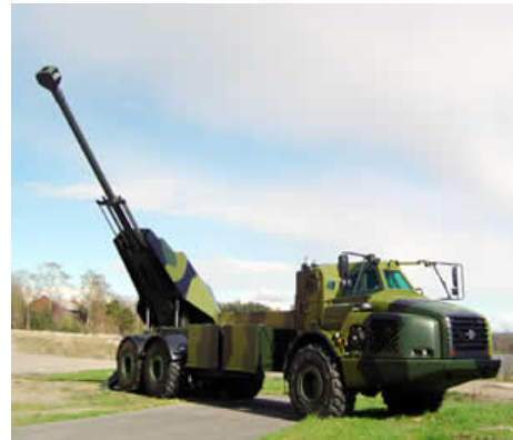
В Швеции проходят стрельбовые испытания первого опытного образца самоходной артиллерийской системы Archer на шасси FH77 BW L52 6x6, производства шведской компании BAE Systems Bofors.
