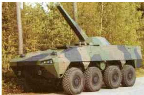
На выставке Eurosatory фирма Patria Weapon Systems продемонстрировала новую 120мм гладкоствольную башенную минометную систему NEMO (NEw MOrtar), установленную на бронированную модульную машину (AMV) 8x8, производства компании Patria Vehicles.
