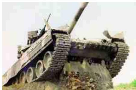
Танковое оборудование для самоокапывания представляет собой отвал, прикрепленный к нижнему наклонному листу передней части корпуса танка и обеспечивающий ему возможность самоокапывания с целью достижения лучшей защищенности при стрельбе с закрытой огневой позиции.
