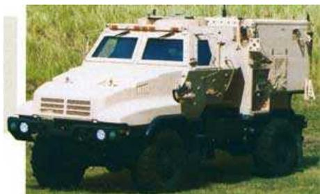
Филиал систем по разработке тактических машин бронетехники завершил собственную разработку варианта семейства средних тактических машин общего назначения с колесной формулой 4x4.
