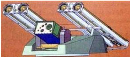
Фирма IST Dynamics (ЮАР) ведет разработку противотанковой ракетной установки для стрельбы с ходу с таких легких бронированных машин, как HMWV, RG32 и Panhard VBL/VBR. Известная под названием «Ракетная стабилизированная платформа» (РСП), она представляет собой стабилизированную башню с вынесенным ракетным вооружением, предназначенным для ведения огня противотанковыми ракетами фирмы Denel. РСП способна поражать подвижные цели с ходу на расстоянии от 200 м до 5000 м.
