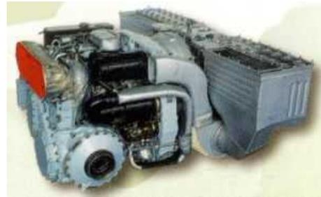
Газотурбинный двигатель (ГТД) — тепловой двигатель, в котором газ сжимается и нагревается, а затем энергия сжатого и нагретого газа преобразуется в механическую работу на валу газовой турбины. В отличие от поршневого двигателя, в ГТД процессы происходят в потоке движущегося газа.
