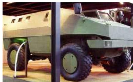
В сентябре на выставке «Аэрокосмос и Оборона 2006» в г. Кейптаун (ЮАР) впервые официально представлена усовершенствованная машина FV4 290 с колесной формулой 4x4 (вариант БМ Iguana) и противоминной защитой. Машина спроектирована и разработана фирмой Industrial and Automotive Design (IAD).
