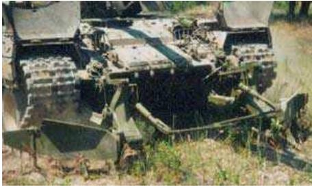
Колейный минный трал ножевого типа является навесным оборудованием на танк и предназначен для обеспечения преодоления танком минных полей из противотанковых противогусеничных мин. Принцип работы трала основан на выглублении мин и отбрасывании их за пределы проекции гусениц.
