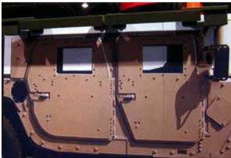
В США проходит испытания система защиты от РПГ с кумулятивными боеголовками. Система предназначена для защиты легкобронированных машин, например, многофункциональной колесной машины M1114 высокой маневренности, и характеризуется малозатратным механизмом ее изготовления и минимальной опасностью поражения собственных войск.
