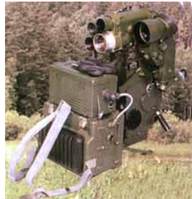
Российское конструкторское бюро точного машиностроения им. Нудельмана разработало новую "противооптическую" систему, предназначенную для противодействия снайперам, использующим оптические прицелы.
