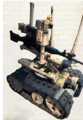
SWORDS - версия наземного робота фирмы Foster Miller, снабженная телепередающей быстроснаводящейся платформой, дистанционно управляемая, изготавливается фирмой Precision Remotes.
