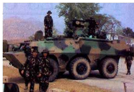
Народная освободительная армия Китая готовится использовать уже зарекомендовавший себя бронетранспортер WZ 551, производства NORINCO для выполнения ряда специальных разведывательных операций.
