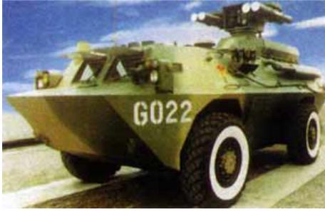
Китайская корпорация NORINCO (North Industries Corporation) предлагает на рынке усовершенствованную версию противотанковой управляемой ракеты Red Arrow 9, которая устанавливается на подставку. Новая система получила обозначение Red Arrow 9A.
