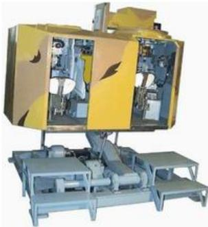
К средствам отработки взаимодействия внутри экипажа бронетехники относятся тренажеры экипажей, которые образуются путем соединения средств индивидуальной боевой подготовки (тренажеров членов экипажа) в единую сеть. На виртуальном полигоне такой экипаж представлен единым объектом – будь то танк, БТР либо другая боевая машина, тренажер экипажа которой требуется подготовить.
