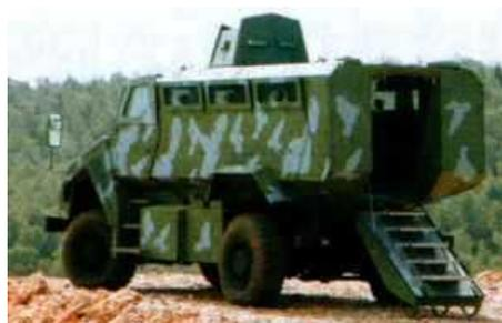
На выставке Eurosatory 2008 израильская компания Hatehof Industries продемонстрировала две бронированные машины: Navigator - 16-тонную машину с усиленной противоминной защитой (MRAP) и колесной формулой 4x4 в модификации бронетранспортер и Xtream - 16-тонную многоцелевую машину с колесной формулой 4x4 и повышенной проходимостью.
