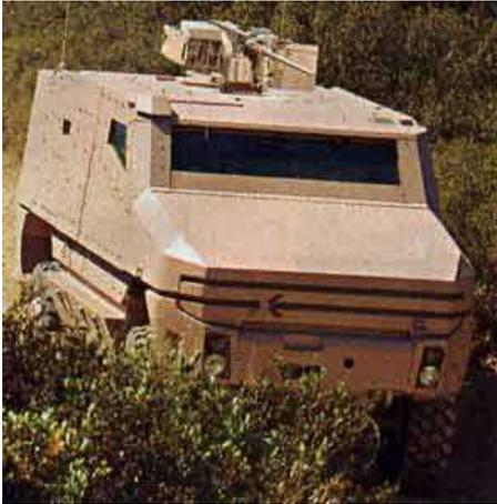
Nexter заявляет, что Aravis, сделанная на базе шасси Unimog U5000, является самой защищенной машиной в своем классе. Представитель компании сообщил, что машина изначально разрабатывалась как машина с усиленной противоминной защитой для участия в операциях в Ираке и Афганистане.
