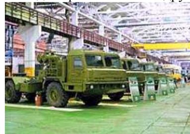
На шасси "БАЗ" смонтированы тактические ракетные комплексы "Луна" и "Точка", зенитно-ракетный комплекс "Оса", реактивная
