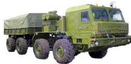
Несомненный интерес у специалистов и посетителей вызовет опытный образец специального колесного шасси БАЗ-М6910Э, представляющий собой ходовой образец перспективной высококомбинированной автомобильной платформы с электротрансмиссией.
