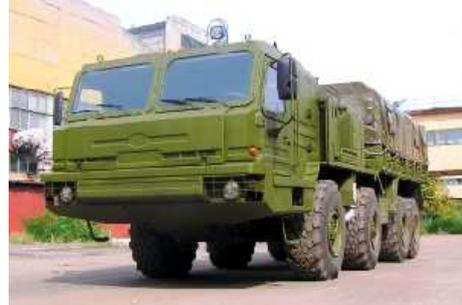
Второй, не менее интересный образец, - балластный тягач БАЗ-6306У с локальным бронированием, предназначенный для буксировки прицепных (артиллерийским) систем и транспортных прицепов по всем видам дорог и местности, а также летательных аппаратов. При полной массе не более 42 т грузоподъемность тягача достигает 24 т и позволяет буксировать летательные аппараты полной массой до 150 т.
