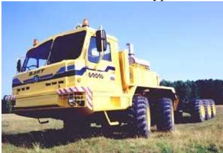
На выставке будет представлена ремонтно-эвакуационная машина (РЭМ-КС) на базе БАЗ-6910. РЭМ-КС предназначена для проведения технического обслуживания и текущего ремонта в полевых условиях и эвакуации специальных колесных шасси и тягачей БАЗ и автомобилей повышенной грузоподъемности типа "КАМАЗ" и "Урал".
