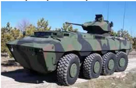
В ходе полевых испытаний в ОАЭ в 2008 Pars продемонстрировал замечательную мобильность в условиях пустыни. Он имеет возможность преодолевать водные преграды вплав, используя для перемещения прокручивание колес. С помощью опциональных водометов он может развивать более высокую скорость на воде и лучше маневрировать.
