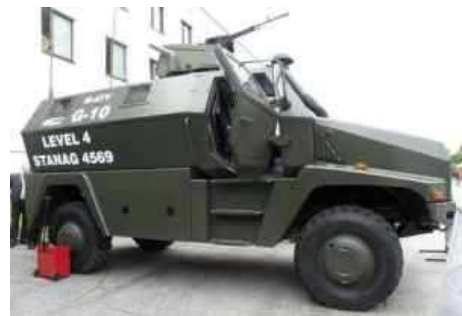
На выставке в Кельце польская компания Dom Samochodowy GERMAZ SP. Z O.O. представила машину, аналог американской M-ATV — машину высокой проходимости с противоминной защитой.
