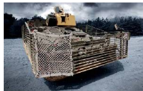
Комплект решетчатой брони на текстильной основе QuickShield предлагается в качестве комплекта быстрого ремонта для включения в
