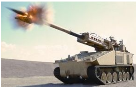
Самоходная установка NLOS-C (артиллерийская система для ведения огня с закрытых позиций), создаваемая по программе FCS, за время проведения полевых испытаний выпустила более 1000 снарядов.
