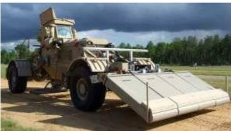
Армия США заключила с компанией НИТЕК, Inc контракт на поставку георадара (Ground Penetrating Radar - GPR) навесной системы обнаружения Husky (Husky Mounted Detection System - HMDS).
