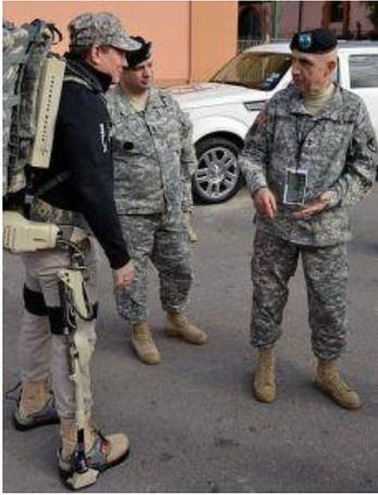
Lockheed в настоящее время проводит оценку разработанных Protonex Technology системы электроснабжения на топливных элементах, что позволит роботу-экзоскелету HULC работать на одной зарядке более чем 72 часа при выполнении сложных задач.
