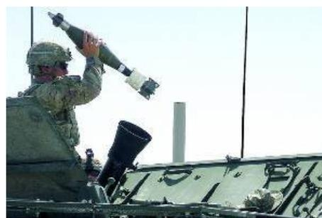
Первая машина Stryker в Афганистане провела стрельбы 120-мм осколочно-фугасными минами высокой точности АРМІ (разработанные по программе Accelerated Precision Mortar Initiative — Инициатива ускоренного точного миномета), которые обеспечивают прямое попадание в цель с первого выстрела.
