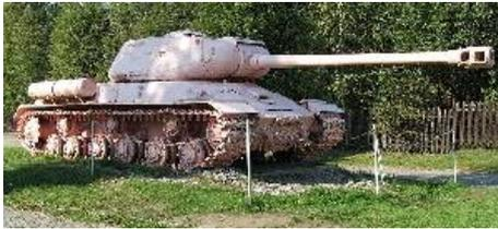
Тяжелый танк - танк большой массы (по классификации, принятой в 50-60-е годы в СССР - свыше 40 тонн) с более высоким по сравнению с другими танками уровнем защиты и, как правило, более мощным вооружением.
