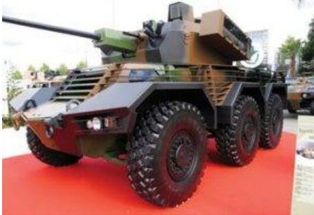
>Башня Lance разработана Rheinmetall и предлагается в обитаемом и дистанционно управляемом вариантах. Она была интегрирована на различные колесные шасси.
