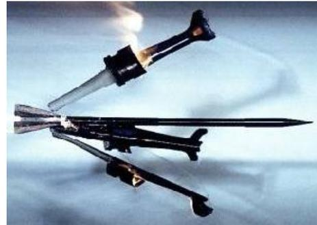
Отделяющийся поддон бронебойного подкалиберного снаряда - составная часть бронебойного подкалиберного снаряда, предназначенная для уплотнения камеры, центрирования снаряда и ведения его активной части по каналу ствола.
