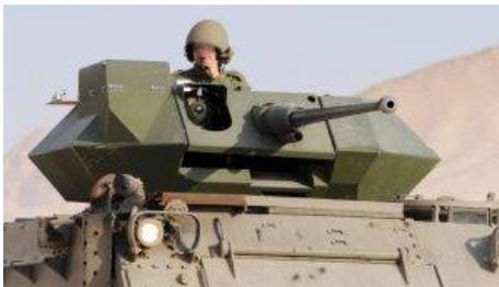
Опираясь на опыт, накопленный при производстве боевого модуля Samson 30 Mk1, израильская компания Rafael разработала Samson 30 Mk2, в котором пушка ATK MK44 калибром 30 мм вместе с системами защищена броневым корпусом, обеспечивающим 1-й уровень защиты, который может быть увеличен до 4-го уровня благодаря дополнительной накладной броне.
