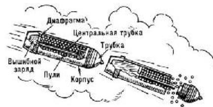
Снаряд с готовыми поражающими элементами - артиллерийский снаряд основного назначения, внутренняя полость которого (камера) заполнена готовыми поражающими (убойными) элементами (ими могут быть шарики, иголки, кубики, стрелки специальной формы и т.д.) совместно с вышибным или разрывным зарядом.
