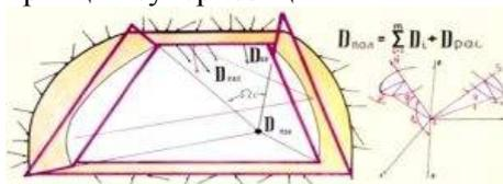
Здесь  $\Omega_i$  - телесный угол, исходящий из расчетной точки к краям  $i$ -того элемента защиты.
