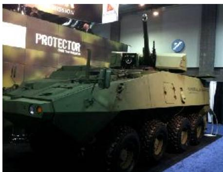
В начале следующего года во время официальных маневров армии США в Форте Беннинг, штат Джорджия, пройдут испытания бронированной машины Stryker, вооруженной новым боевым модулем со стабилизированной 30-мм пушкой. Целью является увеличение огневой мощи колесных бронетранспортеров.
