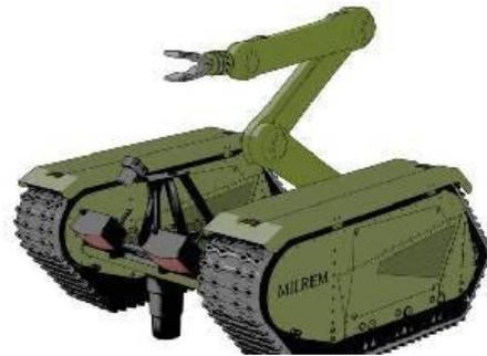
Эстонская компания MILREM расширила список функций своей наземной беспилотной платформы (UGV) THeMIS (Tracked Hybrid Modular Infantry System – гусеничная гибридная модульная система пехоты), установив на платформу устройство для обезвреживания самодельных взрывных устройств (СВУ).
