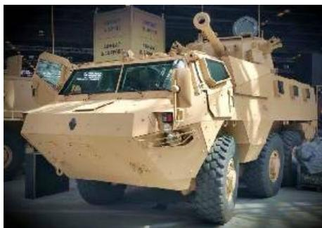
На выставке Eurosatory 2016, которая проходит в Париже, французская компания Renault Trucks Defense представила свою последнюю версию бронированной машины VAB Mk 3, оснащенной бельгийской двухместной башней CSE 90LP от CMI Defence, вооруженной пушкой низкого давления 90 мм, 7,62-мм спаренным пулеметом и вынесенным пулеметом.
