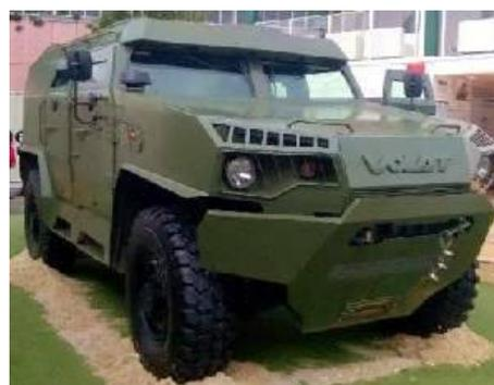
ВОЛАТ МЗКТ-490100 представляет собой машину класса MRAP, первоначально разработанную ООО МЗКТ в качестве частной инициативы. Машина имеет цельносварной корпус из броневой стали с V-образной формой днища. Она обеспечивает высокую защищенность экипажу и превосходную внедорожную мобильность, при этом может эксплуатироваться в городских, горных условиях, а также в труднопроходимой сельской местности.
