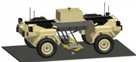
750-килограммовая машина полностью симметрична, то есть ей не нужно разворачиваться, чтобы поехать назад. Он не имеет варианта исполнения с водителем на борту, а на центральном грузовом модуле машины можно разместить полезную нагрузку весом до 750 кг, может размещаться над или под основной рамой.
