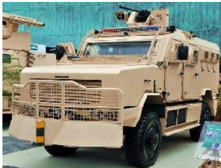
Компоновка SOFRAME ARIVE является стандартной, с силовым отделением спереди, экипажем (водителя и командира) в среднем отделении и десантом - заднем. Машина может перевозить в общей сложности до 12 военнослужащих, включая водителя и командира. Восемь пехотинцев могут сидеть в задней части корпуса на отдельных сиденьях, размещенных вдоль бортов, лицом друг к другу. Еще двое размещаются спереди, за местами командира и водителя.
