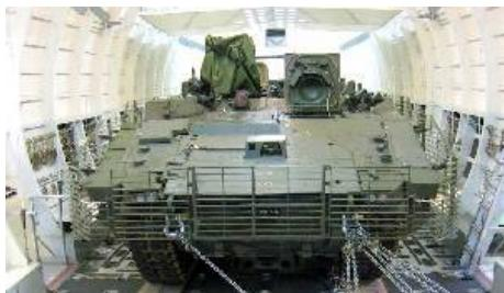
Компания General Dynamics Land Systems-UK завершила предварительные испытания авиатранспортабельности семейства боевых машин AJAX, проходившие в Объединенном экспертично-испытательном отделе воздушных перевозок (Joint Air Delivery Test and Evaluation Unit — JADTEU) на базе королевских военно-воздушных сил Brize Norton.
