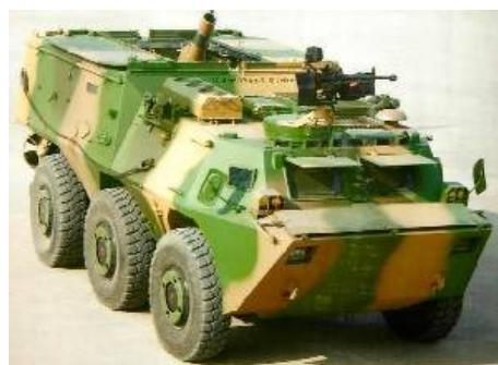
Китайская компания NORINCO предлагает на экспорт новую версию широко распространенного колесного плавающего бронетранспортера WMZ-551 6x6 со 120-мм минометом, получившую название SM4 120 мм.
