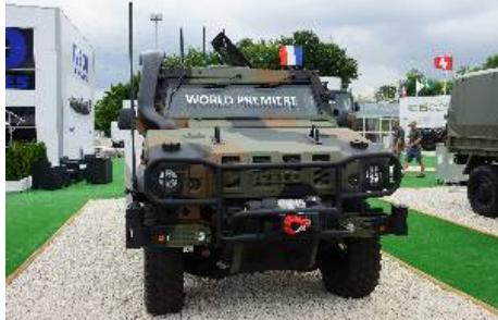
LMV 2 имеет новый двигатель мощностью 220 л.с. и модернизированную трансмиссию, а также автоматическую систему управления движением, которая имеет блокировку дифференциала, что повышает проходимость машины. LMV 2 также получила электронную систему обеспечения устойчивости, которая улучшает ее поведение на бездорожье и предотвращает опрокидывание машины.
