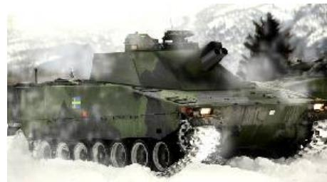
Установка минометной системы, известной как Mjölner, разработанной самой компанией, на 40 шасси CV90 значительно увеличит возможность ведения непрямого огня для поддержки механизированного батальона.
