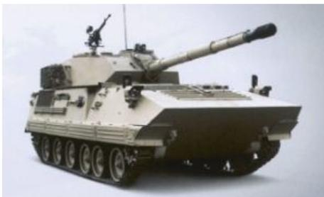
Китайская компания NORINCO расширила свою номенклатуру предлагаемой на рынке бронетехники, создав новый истребитель танков ST2, вооруженный новой 105-мм противотанковой пушкой. Машина разрабатывалась специально для экспортных
