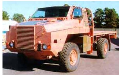
Австралийская фирма ADI Limited раскрыла детали своей новой машины из семейства бронированных машин с противоминной защитой Bushmaster с колесной формулой 4x4.
