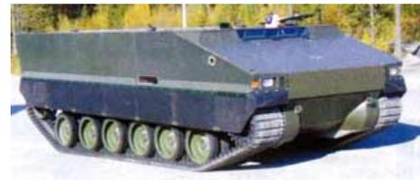
BAE Systems Land Systems Hagglands выпустила второй, на этот раз гусеничный, образец модульной тактической машины SEP (Splitterkyddad Enhet-sPlattform) - T2.
