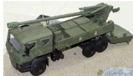
Турецкая компания Makina ve Kimya Endustrisi Kurumu (МКЕК) разрабатывает 155-мм самоходную артиллерийскую систему, базирующуюся на колесном шасси повышенной проходимости 6x6.
