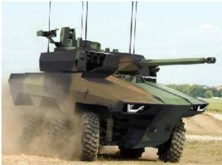
Jaguar - бронированная машина с колесной формулой 6x6, оснащенная двухместной башней 40 СТАС, вооруженной одной 40-мм пушкой СТС, которая ведет огонь телескопическими боеприпасами. 40-мм пушка будет иметь дальность стрельбы 1500 метров. 40 СТС может включать в себя несколько типов боеприпасов в одной и той же системе обработки боеприпасов, что дает машине возможность быстро вступать в бой.
