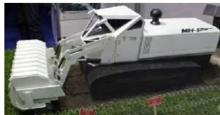
На выставке Partner 2017, которая прошла в Белграде, компания TRB из Боснии и Герцеговины представила новую гусеничную машину для разминирования МН-17.
