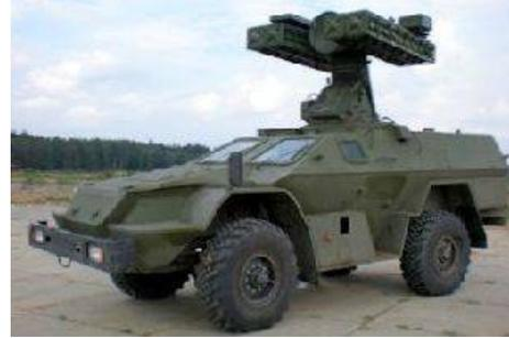
Дизельный двигатель с турбонаддувом в БПМ-97 обеспечивает мощность 240 лошадиных сил и максимальную скорость 90 км/ч при запасе хода до 1000 км. БПМ-97 не имеет возможности плавать, но преодолевает водные препятствия глубиной 1,75 м при соответствующей подготовке.
