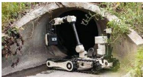
Компания Roboteam воспользовалась возможностью на Глобальном симпозиуме и выставке саперных средств в Мэриленде, чтобы продемонстрировать свою новейшую линейку беспилотных машин (UGV), которая включает в себя новый Легкий интероперабельный наземный робот LIGR (Light Interoperable Ground Robot) и улучшенный Групповой робот для разведки и наблюдения RSTR (Reconnaissance and Surveillance Teamed Robot).
