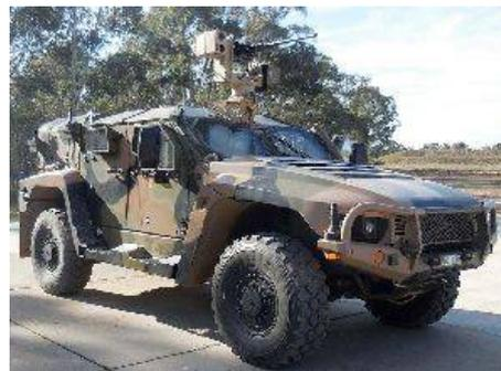
Австралийская компания Electro Optic Systems (EOS) выпустила новейший продукт в своем семействе высокоэффективных боевых модулей с дистанционным управлением. R150 - это стабилизированная, легкая платформа для дистанционно управляемых систем вооружения бронированных машин. Он следует за своим более крупным собратом, R400. Имея около половины веса предшественника, R150 имеет те же рабочие характеристики, что и R400 благодаря тому, что он может оснащаться пулеметами вплоть до калибра 12,7 мм.
