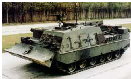
Бронированная ремонтно-эвакуационная машина (БРЭМ) является разновидностью боевой бронированной машины, используемой для ремонта бронированных машин, поврежденных в результате огня противника или взрыва мины, а также вышедших из строя в ходе боя в силу
