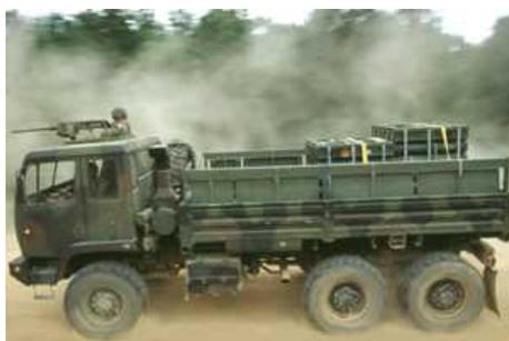
Armor Holdings, Tactical Vehicles Division (США), в марте этого года должно поставить королевской иорданской армии еще одну партию из 45 грузовых автомобилей M1085A1 грузоподъемностью 5 тонн с удлиненной колесной базой (6x6), относящихся к семейству средних машин тактического назначения (FMTV).
