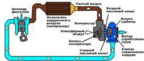
Турбонаддув – один из методов агрегатного наддува, основанный на утилизации энергии отработавших газов. Основным элементом системы – турбокомпрессор, иногда – турбоагрегат. Турбонаддув применяется, в частности, в конструкции танковых двигателей.
