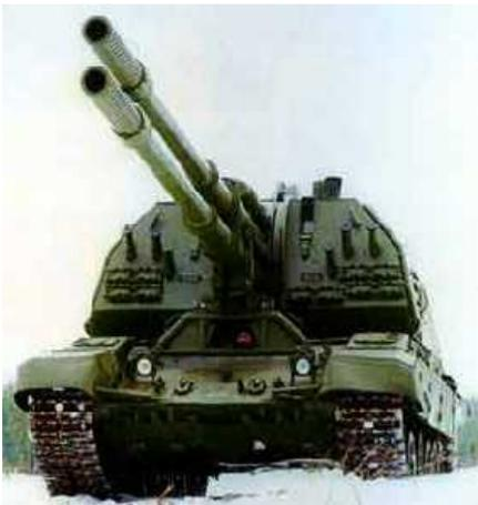
Недавно была продемонстрирована система «Коалиция-СВ», спаренная 152-мм самоходная артиллерийская установка (САУ) уникальной конструкции (Россия). Установка содержит башню системы 2S19, установленную на гусеничном шасси с использованием танковых узлов.
