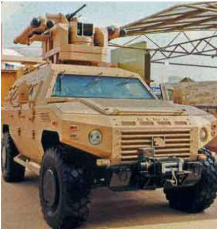
Компания Advanced Industries of Arabia, дочернее предприятие Bin Jabr Group продемонстрировала разработанное в инициативном порядке семейство машин на базе модульной многоцелевой тактической машины (НМТВ) Nimr II с колесной формулой 4x4.
